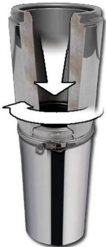
Die Montage der Längenelemente erfolgt über dem Feuerungsanschluss.
